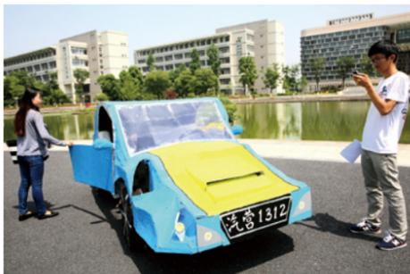
废木头搭建的底盘，旧沙发改装的座椅，泡沫板做的车门，自来水管拼接的车轴，透明塑料包装纸做的前挡风玻璃，矿泉水瓶做的车灯，还有用废旧报纸叠出来的车轮和方向盘……
